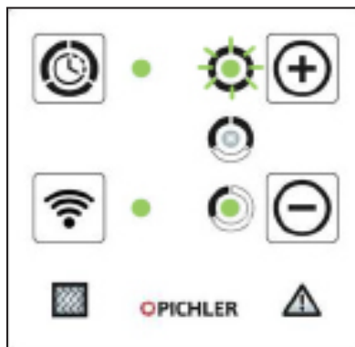
Вентилационна степен 1 Интензивен режим на вентилация за определено време
